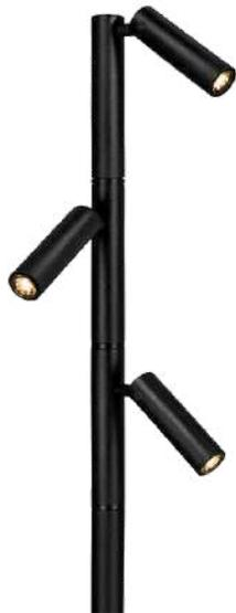
O balizador Orbit Modelo PT5 oferece versatilidade com hastes de 80cm ou 1,2 metros. Fabricado com um, dois ou três spots, seu exclusivo sistema de montagem modular permite direcionar os spots de forma independente, podendo ser utilizado como balizador e espeto (uplight) para iluminar árvores. Fabricado em alumínio usinado e com pintura poliéster eletrostática, sua óptica recuada e antiofusante de fecho médio é a solução ideal para destaque de caminhos e árvores de médio porte.
