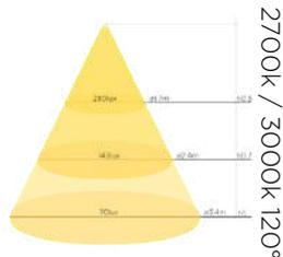
O Balizador Garden Modelo PT3 possui um ângulo de abertura de 120° e luz muito uniforme. Fabricado com base em alumínio e haste de 50cm, é perfeito para iluminar grandes forragens e plantas, destacando e valorizando todas as cores com seu IRC>90. Combinando design sofisticado e durabilidade, a peça é fabricada em alumínio usinado com pintura poliéster eletrostática, proporcionando uma iluminação eficiente e elegante para seu jardim.
